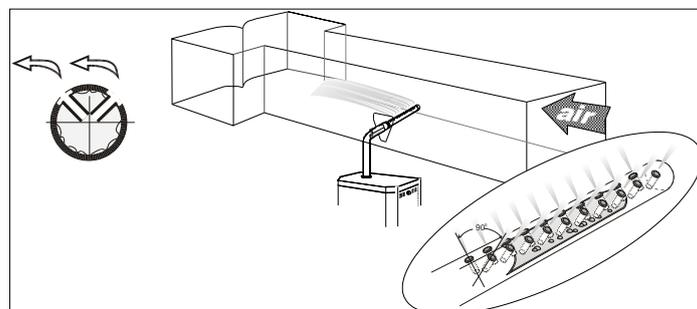
Illustration 14 - Distributeur S.A.M.E2 dans conduit horizontal
