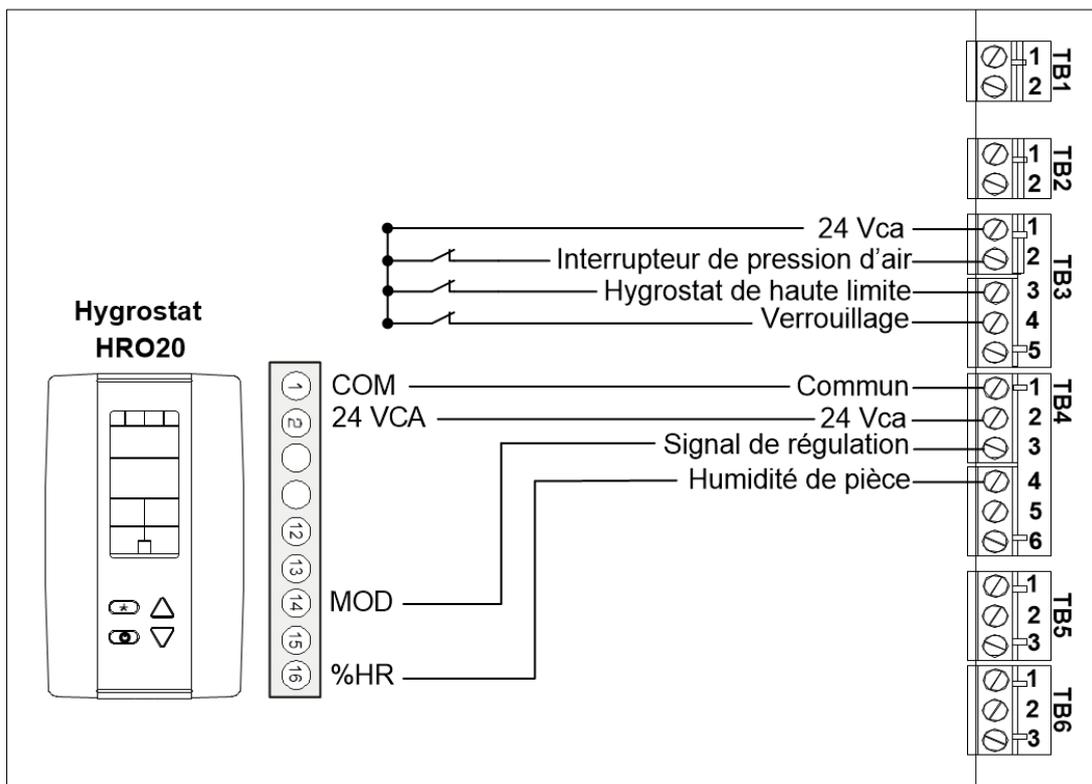
Illustration 42 - Signal de contrôle d'un hygrostat HRO20
