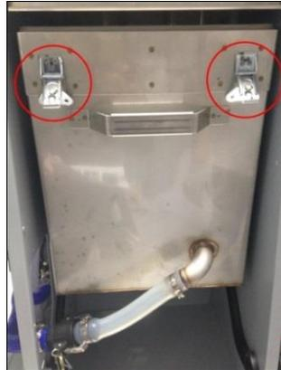
3. Une fois que l'eau supplémentaire a cessé de s'écouler dans la chambre d'évaporation, verrouillez les loquets pour reconnecter la chambre d'évaporation.
