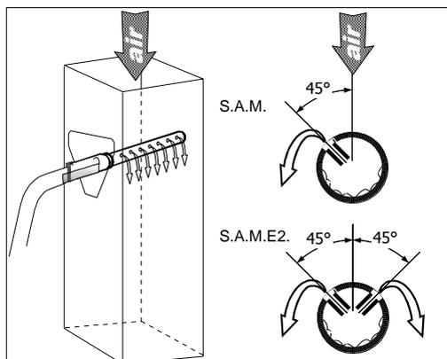
Illustration 15 - Distributeur S.A.M. ou S.A.M.E2 dans conduit vertical
