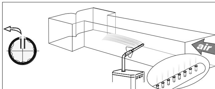
Illustration 13 - Distributeur S.A.M. dans conduit horizontal
