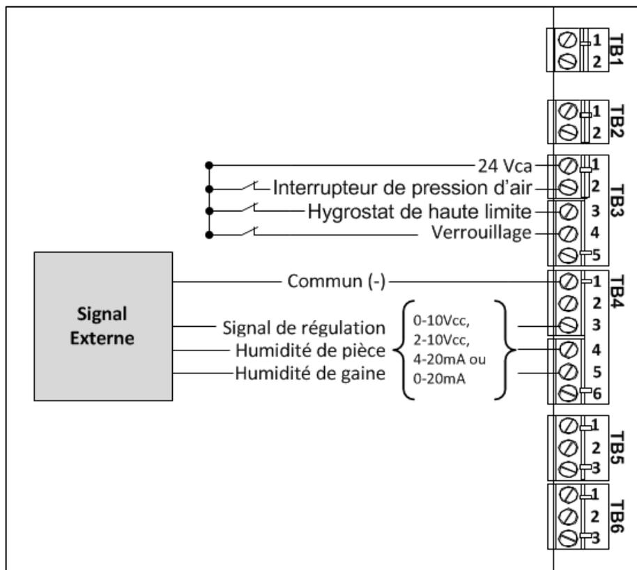
Illustration 45 - Signal de contrôle d'un appareil externe
