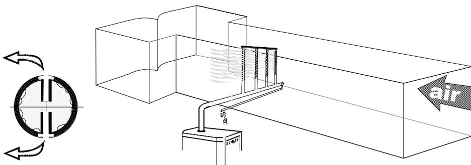
Le système Multi-Steam doit être installé dans des endroits précis des systèmes de contrôle d'air. Plus particulièrement où les distances d'absorption sont très courtes, moins de 900mm, ou lorsque la température dans les conduits d'air est basse.
