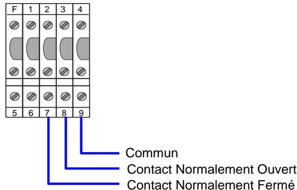
Il est recommandé d'utiliser le contact normalement fermé, ce contact s'ouvrira en cas de condition anormale détectée.
